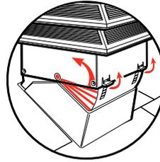
煙囪樣式的設計使得PROVentilator能夠利用風能，產生可強勁地排出閣樓空氣的壓差。
