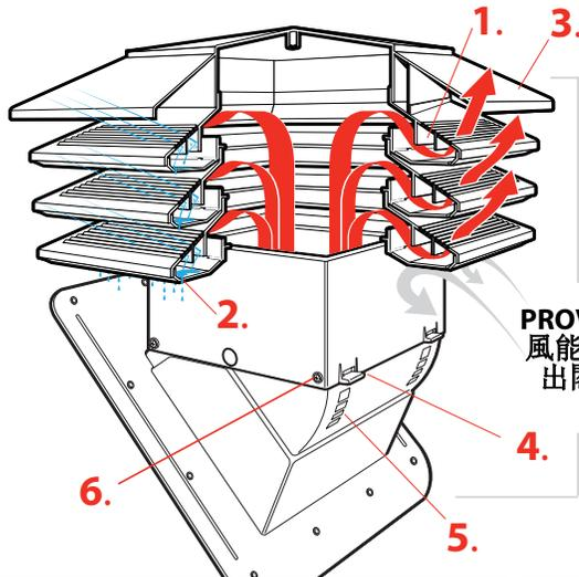
PROVentilator旨在利用風能，產生可強勁地排出閣樓空氣的壓差。
